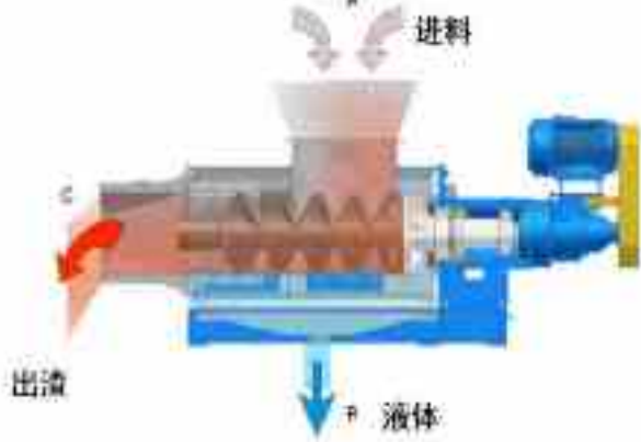
图7-2 螺旋压榨机工作原理图
